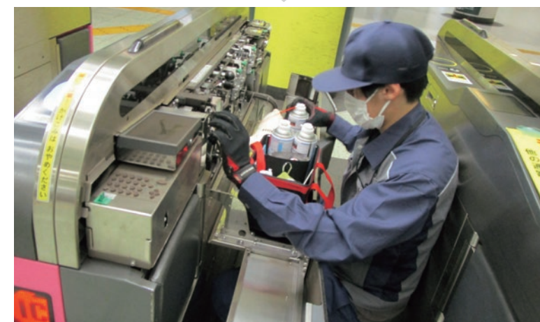
自動改札機の保守点検 ▶
